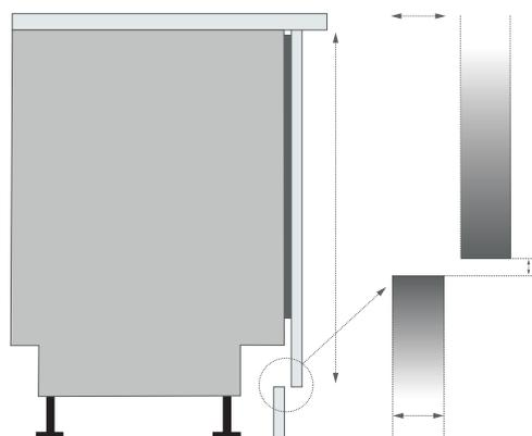
Durch die Schlepptür-Scharniere wird die Anbringung der Frontplatten aus verschiedenen Materialien mit einem Gewicht von 3 kg bis 10 kg und einer Dicke von 16 mm bis 25 mm ermöglicht.
